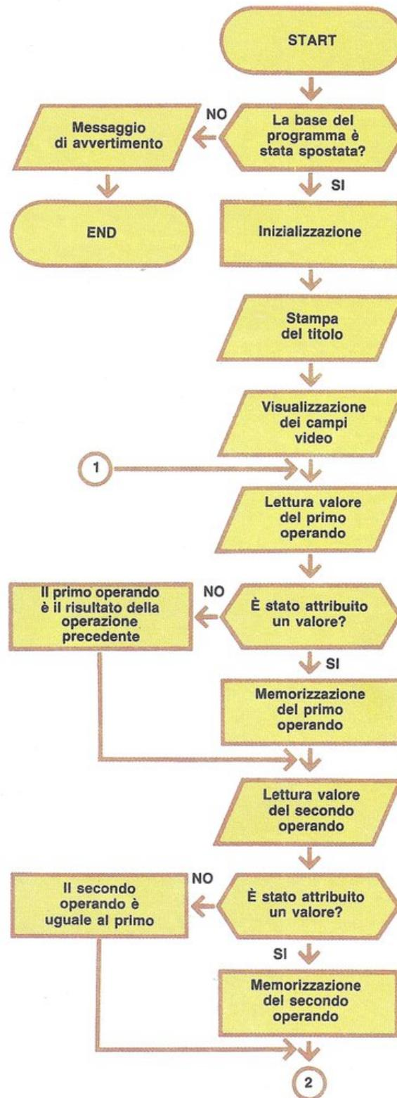
Una volta stabilito il valore degli operandi, il programma attende istruzioni dall'utente per attivare la somma o la moltiplicazione, o per terminare l'esecuzione. Il comando immesso sarà utilizzato all'interno di un ciclo per eseguire l'operazione desiderata dall'utente.
